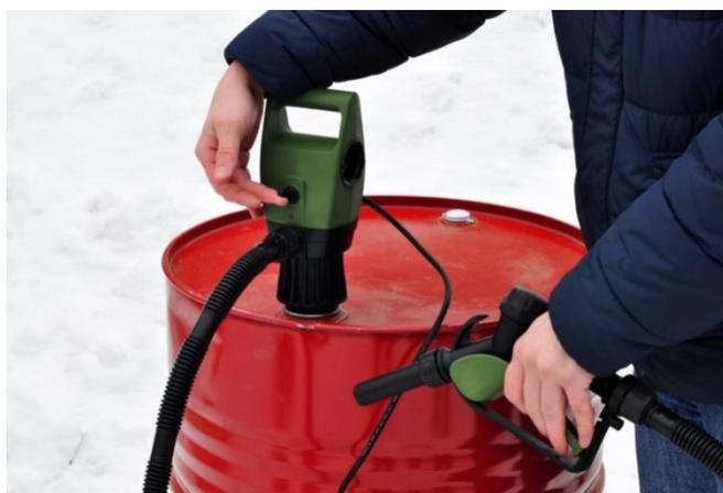
**Рис. 1.** Электрическое устройство для заправки бака пенообразователя пожарной техники
