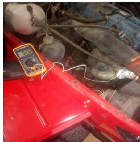
**Рис. 1.** Исследование изменений температуры радиатора пожарной цистерны АЦ-5.5-40(5557)
