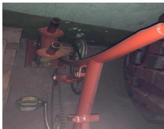
**Рис. 2.** Универсальное и автономное устройство для заправки бака пенообразователя пожарной техники
