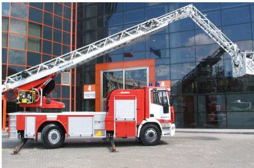
**Рис. 3.** Разложенная пожарная автолестница MAGIRUS M 32 L-AS
